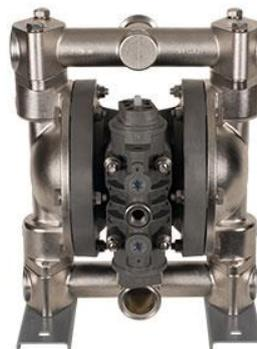
Компания Yamada представляет мембранные насосы пищевого исполнения для пищевой, а также с возможностью применения в фармацевтической и косметической промышленности. В этих мембранных насосах все рабочие органы агрегата, контактирующие с жидкостью, выполнены из пассивированной нержавеющей стали AISI 316 S.S., пневмопривод с эпоксидным покрытием, стандарт подсоединения соответствует гигиеническим нормам, материал мембраны сертифицирован для использования с пищевыми продуктами.
