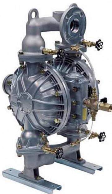
Высоконапорные насосы Yamada 2:1 были спроектированы специально для условий, где максимального рабочего давления в 7 бар недостаточно для удовлетворения системных требований. Производительность насоса приблизительно в два раза меньше стандартных насосов того же типоразмера, а создаваемое давление достигает 14 бар при давлении подаваемого воздуха всего 7 бар. Соотношение 2:1 достигается благодаря передаче давления одновременно на поверхность 2 диафрагм.
