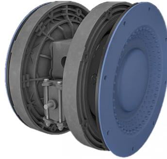
Мембраны (диафрагмы) для насосов с пневмоприводом имеют изогнутый профиль, благодаря чему уменьшается концентрация напряжения по всей длине хода и увеличивается срок службы мембраны. Обратите внимание, что при выборе материала мембраны следует учитывать химическую устойчивость и максимальную температуру перекачиваемой среды/жидкости.
